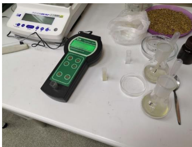
Рис 8. Процесс измерения оптической плотности проб фотоколориметром
